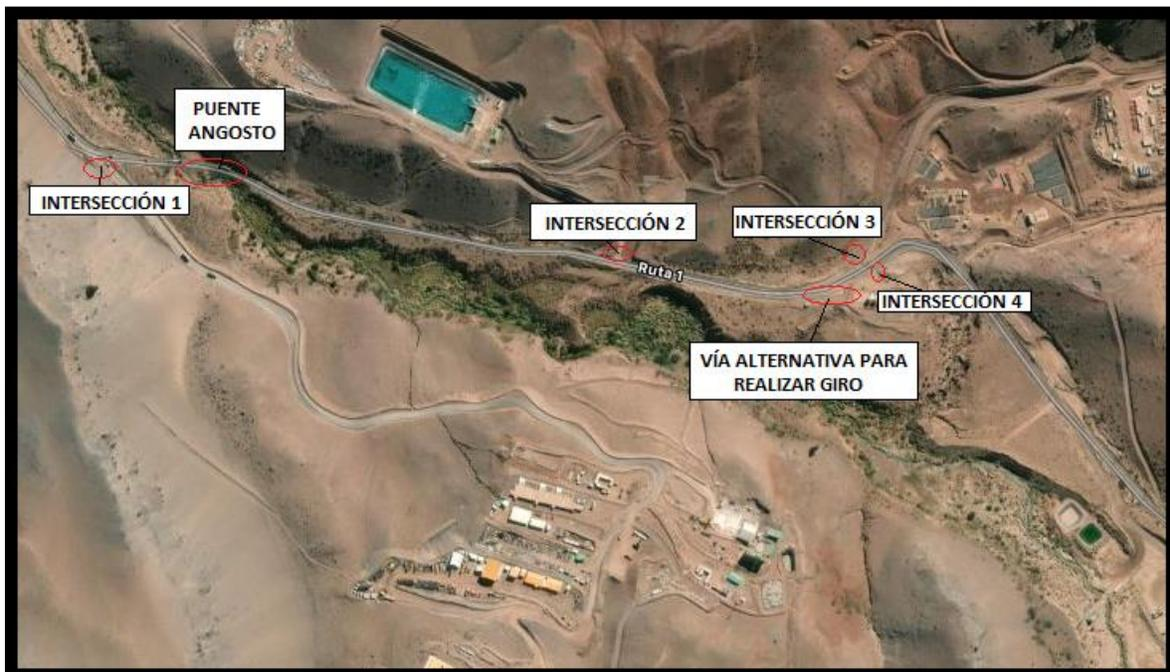
Figura N°6: Sector con diversas intersecciones y variaciones importantes en el número de carriles y ancho de la vía entre el km x y x.
